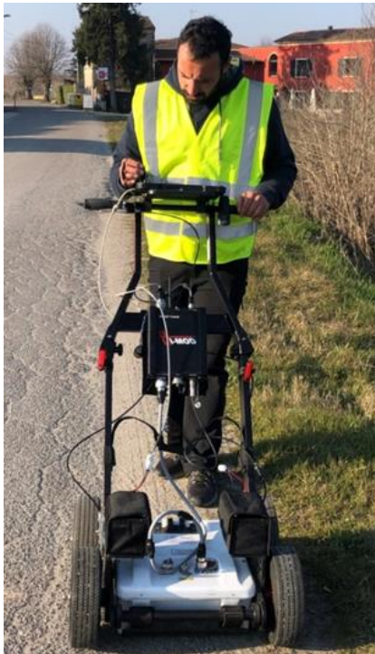
Figura 3. Indagini eseguite con il Georadar, modello Ris MF HI-MOD1
