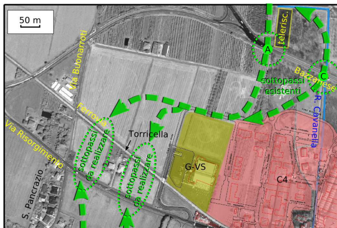
Figura 1-17 – Ipotesi alternative per il sottopasso "est" (Scala 1:10.000). Retini da PRG: G-VS - verde pubblico attrezzato a sport; C - zone da edificare per destinazioni prevalentemente residenziali
