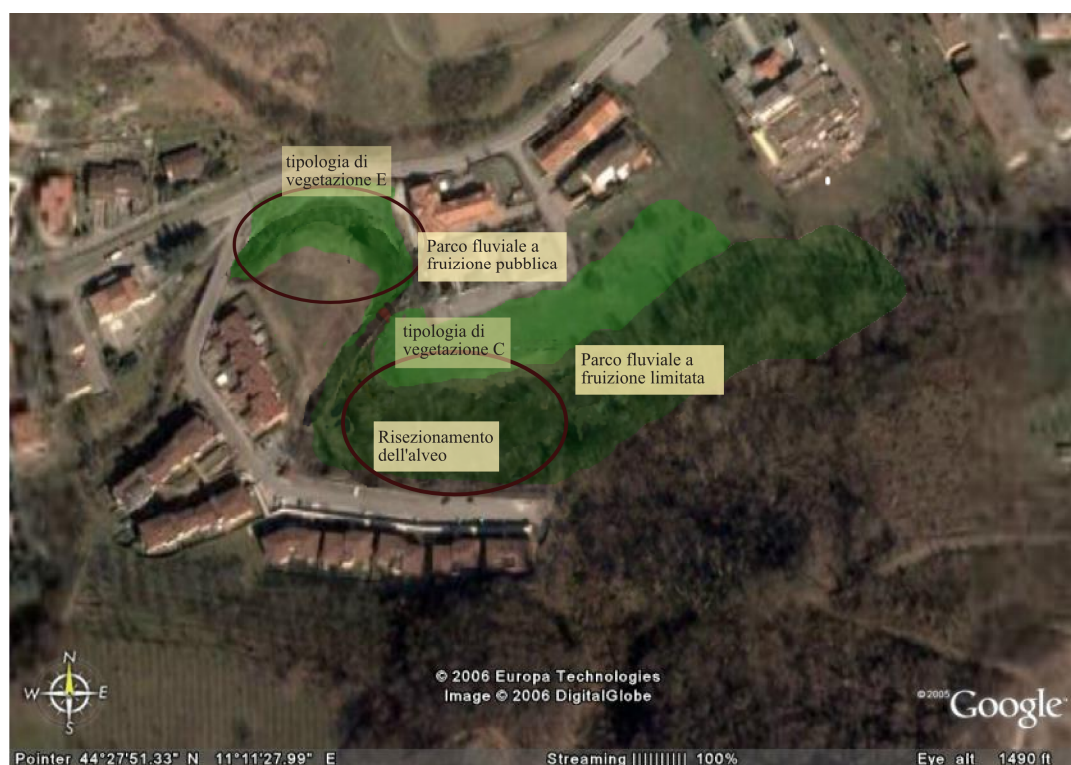
ipotesi di sistemazione per il parco fluviale: rivegetazione delle sponde, risezionamento dell'alveo e divisione del parco in due ambiti a diversa fruizione
